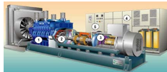
Abb. 1: dynamische USV-Anlage (No Break) Quelle: Eurodiesel
